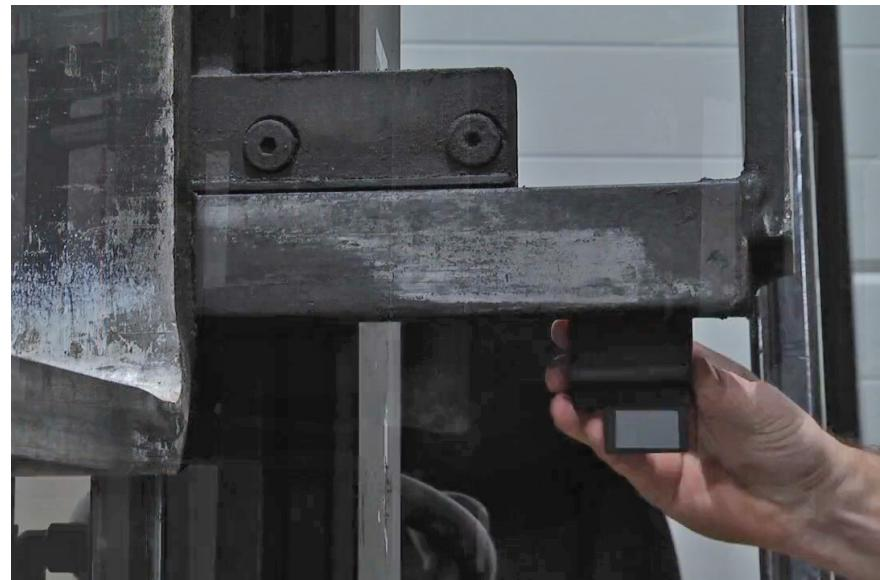
3. Positionnez l'accessoire le plus à gauche possible pour maximiser l'angle de faisceau des lignes laser. Lorsque l'unité est montée sur le support, l'unité ne doit pas dépasser du côté.
