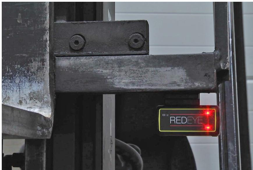
5. Pendant le fonctionnement, la ligne laser supérieure doit apparaître sur la paroi latérale de la fourche gauche, approximativement au milieu. Si la ligne atteint un niveau trop bas ou trop haut, le support doit être remplacé par celui qui convient le mieux.
