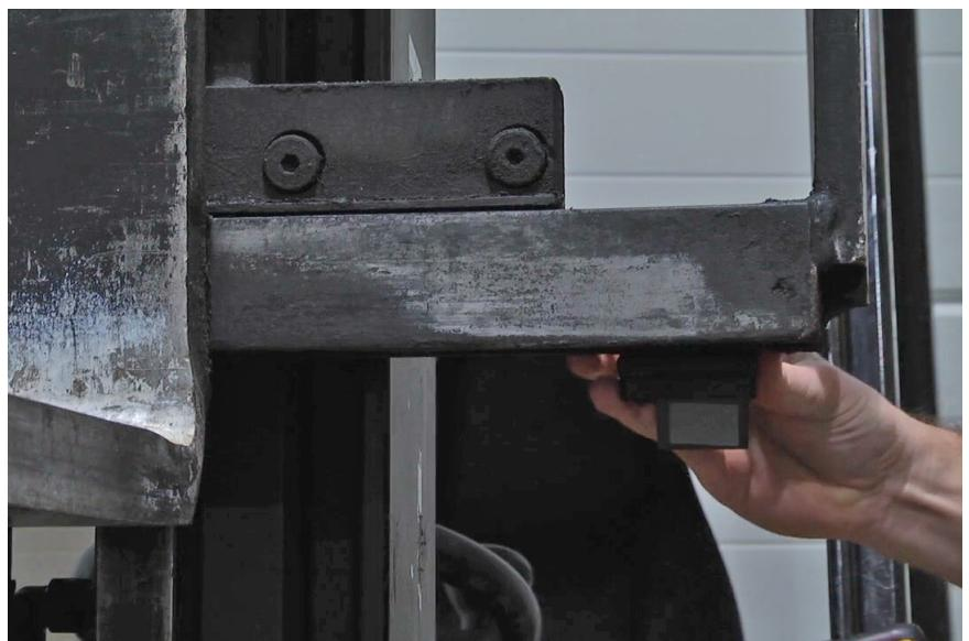
4. Lorsque le support est droit et stable, le dispositif RedEye peut être fixé au support. Une plaque métallique à l'intérieur du haut de l'unité glissera contre l'aimant inférieur du support et maintiendra l'unité solidement en place.
